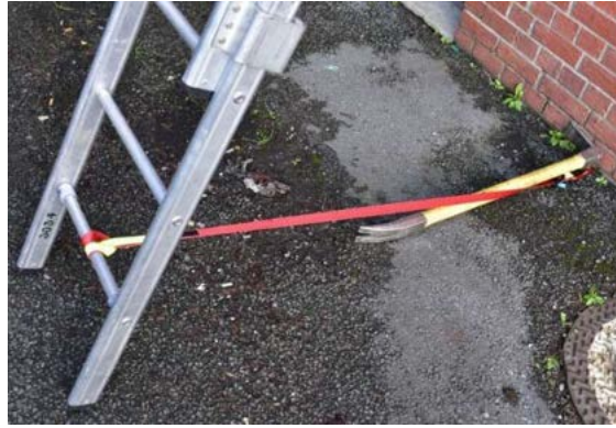
Au moyen d'un Halligan Tool et d'une sangle multifonction (boucle ou connecteur dans le pointeau) © SDIS 59
