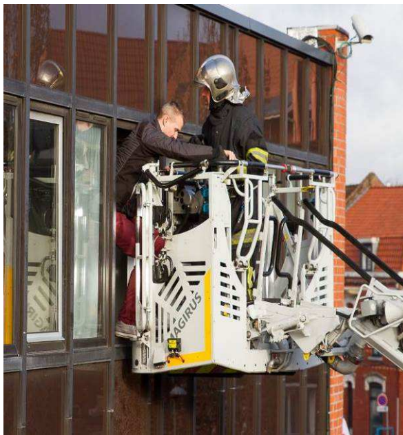
Le panier de secours et l'ouvrant se situent au même niveau.
