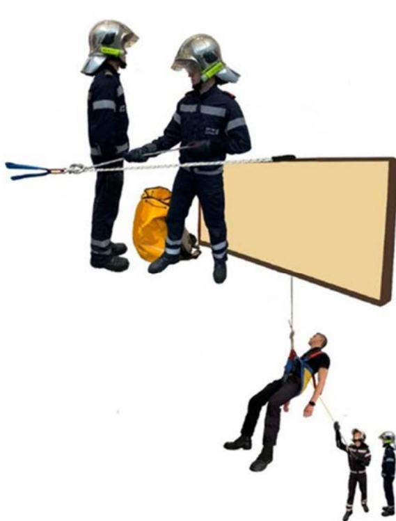
Sauvetage par l'extérieur avec un point fixe © Nicolas Pereira – BPPM
