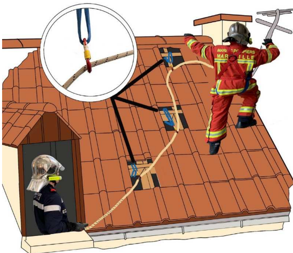
Exemple de manœuvre de progression en toiture © Nicolas Pereira – BPPM
